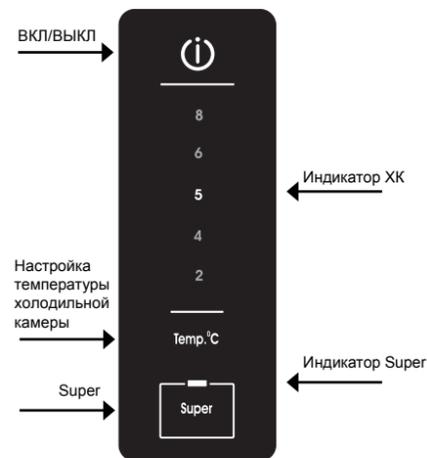
**Вкл/Выкл** - нажатием данной кнопки можно включить весь прибор в целом (как холодильную, так и морозильную камеру). Для отключения холодильника достаточно нажать кнопку.
